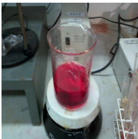
Figura 17. Preparo da solução de Direct Red 23 – 9 mL de água e 1 mL de corante, pH 2,5.
