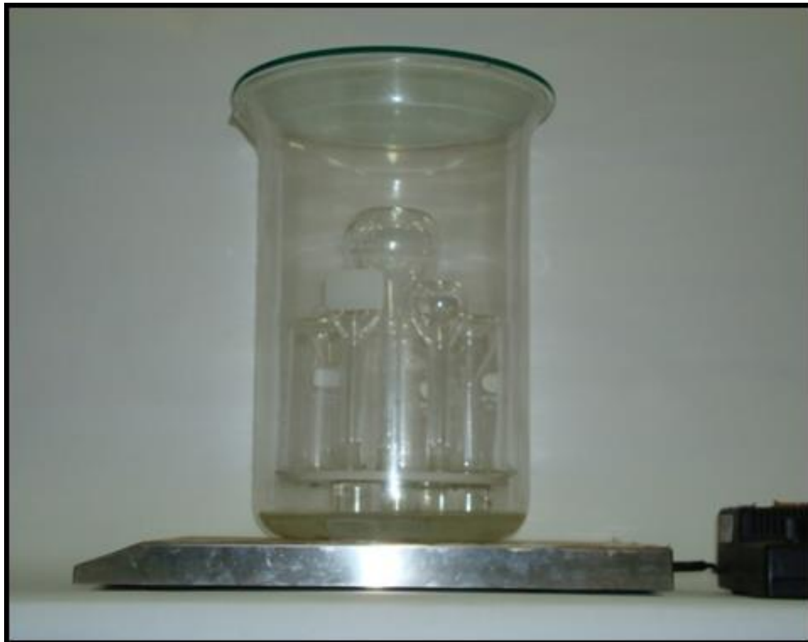
Figura 10 – Sistema utilizado para limpeza de vidrarias em meio ácido nítrico.
