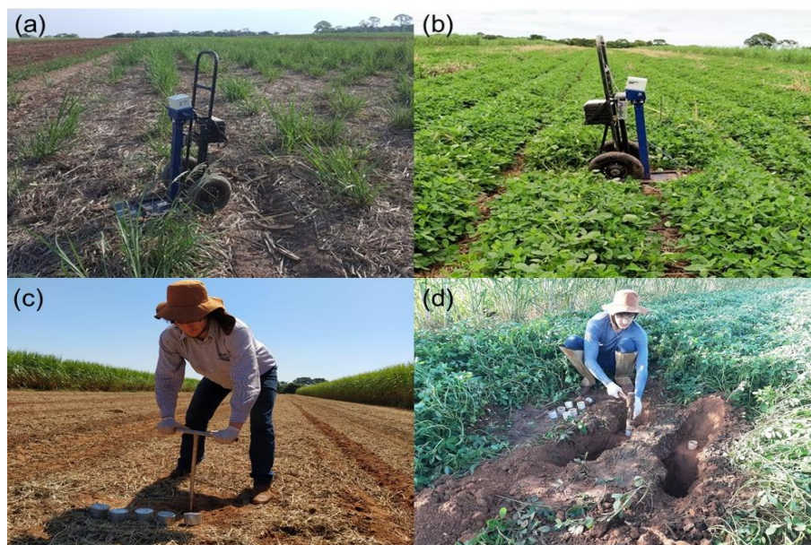
Figura 6. Avaliação de resistência mecânica do solo à penetração antes da semeadura (a), florescimento inicial (b), amostragem do conteúdo gravimétrico de água no solo (c) e amostragem dos atributos físicos cilindros volumétricos (d).
