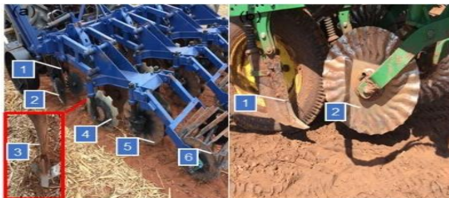
Figura 2. Equipamento utilizado no preparo localizado (a) e seus componentes: disco de corte (a1), discos dentados (a2), haste subsoladora (a3), discos recortados (a4), discos corrugados (a5) e rolo destorreador (a6). Haste escarificadora da semeadora adubadora (b1), e disco ondulado de corte (b2).
