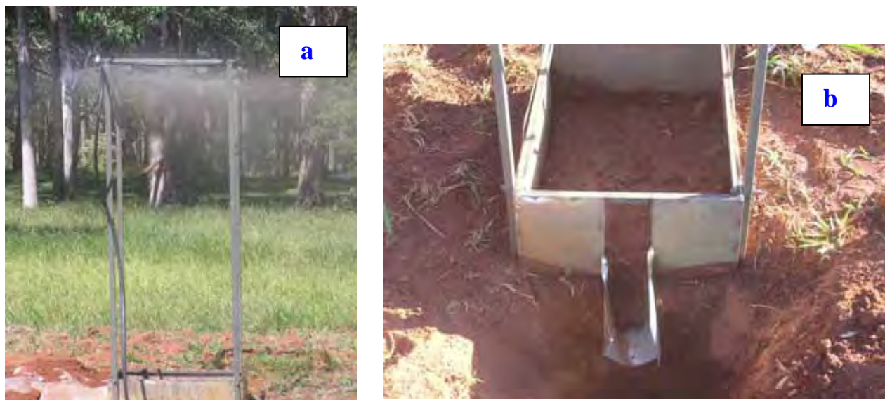
Figura 12. Simulador de chuvas portátil (a) e parcela experimental (b).
