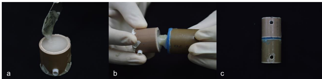
Figura 13 – Inclusão das coroas para o teste de Pull-out
