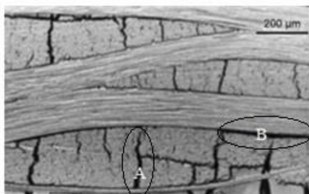
Figura 2.2 – Imagem obtida por MEV de uma microestrutura após tratamento térmico a 900°C mostrando vazios: A) microtrincas e B) microdelaminações.
