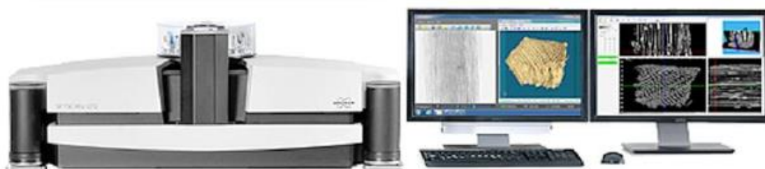
Figura 2.20 – Microtomógrafo Skyscan da Bruker disponibilizado para pesquisa no laboratório LNNano em Campinas/SP
