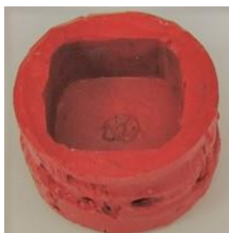
Figura 3.3 – Suporte de silicone resistente a alta temperatura utilizado no processo de imersão dos corpos de prova em resina fenólica, na etapa de reimpregnação.
