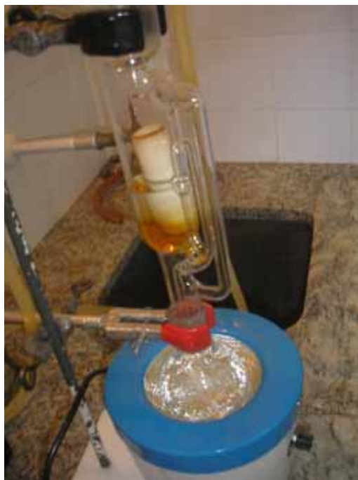
Figura 5 - Extração etanólica da biomassa fúngica em Sistema Soxhlet (1:20 m/v, 78 °C, 12 horas).
