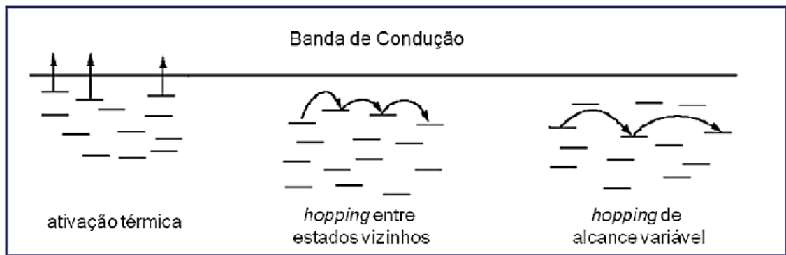
Figura 23: Principais mecanismos de condução encontrados em semicondutores.
