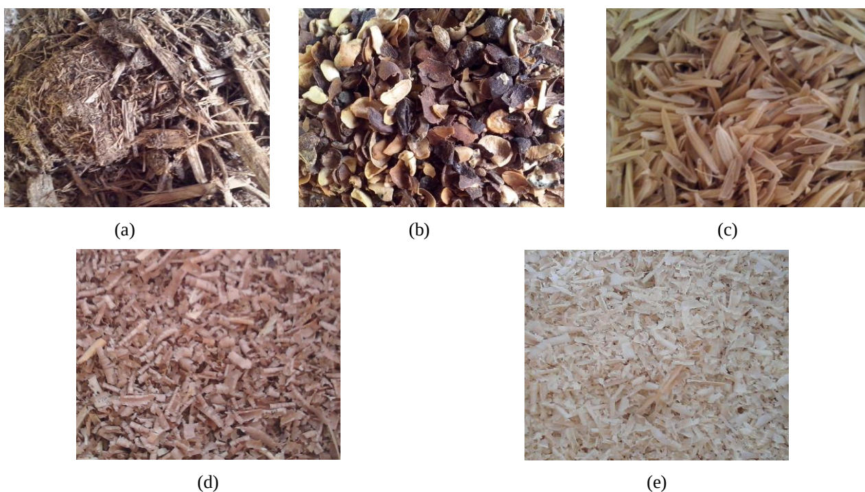
Figura 10 - Biomassas utilizadas neste trabalho: (a) bagaço de cana-de-açúcar; (b) casca de café; (c) casca de arroz; (d) cavaco de eucalipto; (e) cavaco de pinus
