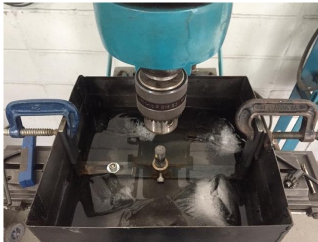
Figura 19- Usinagem do tubo de Venturi em fresa vertical com fixação do tarugo e resfriamento.
