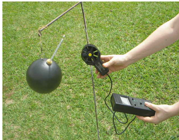
Figura 8. Medida da temperatura do globo negro ( T_g , °C), à uma altura referente ao centro do corpo dos animais e a medida da velocidade do vento com um anemômetro.
