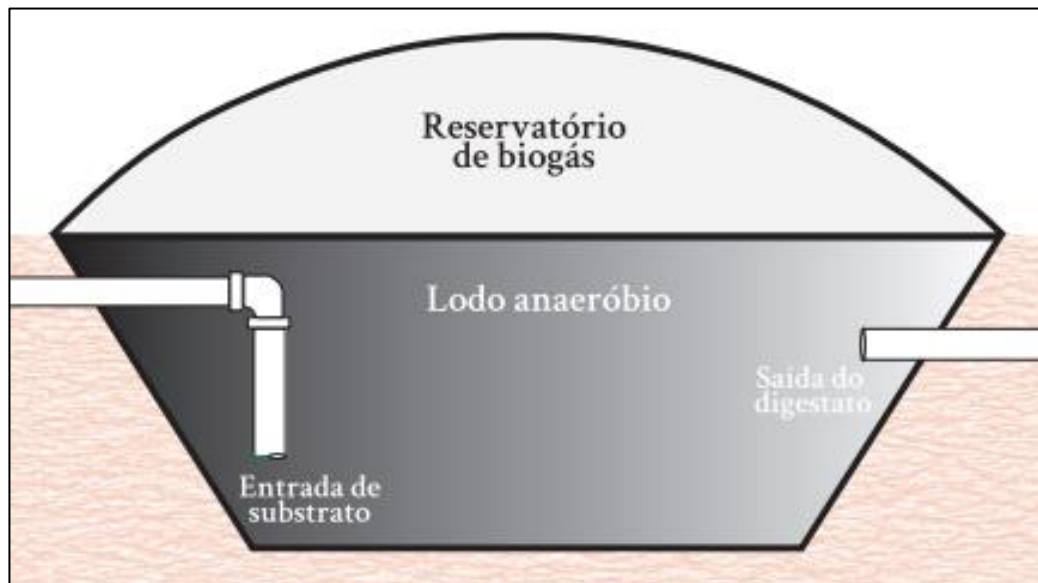
Figura 2 - Representação esquemática de um biodigestor.
