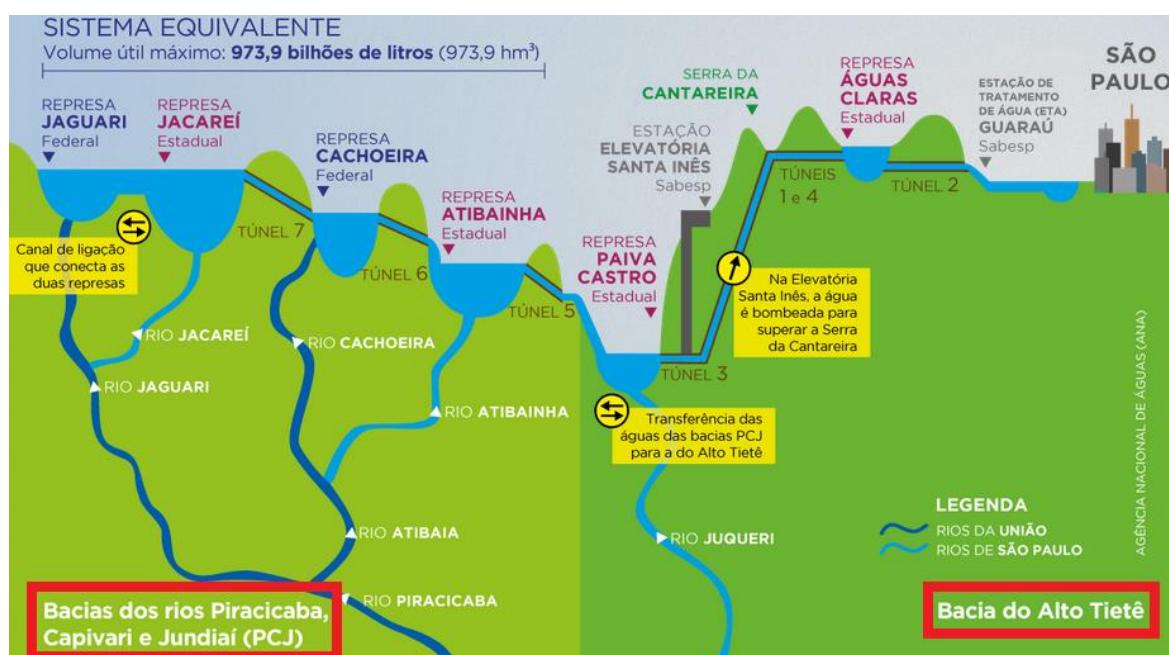
Figura 20: Esquema ilustrativo de funcionamento do Sistema Cantareira
