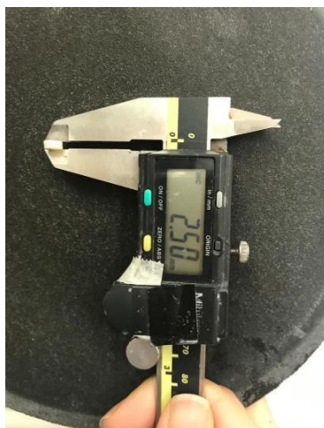
Figura 9- Verificação da dimensão final do corpo-de-prova por paquímetro digital
