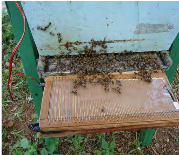
Figura 1: Coletor Elétrico de Veneno, formado por uma placa de vidro e filamentos que conduzem a corrente elétrica.
