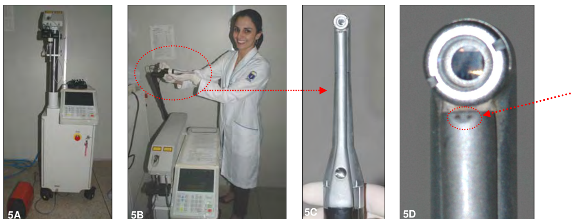
FIGURA 5A/B – Vista frontal do sistema laser de Er:YAG produzido pela Twin Light Fotona Medical Medical Laser (Ljubljana, Slovênia), utilizado durante a confecção de cavidades de classe I.
