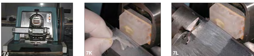
FIGURA 7J – Micrótomo utilizado para obtenção dos cortes histológicos.
