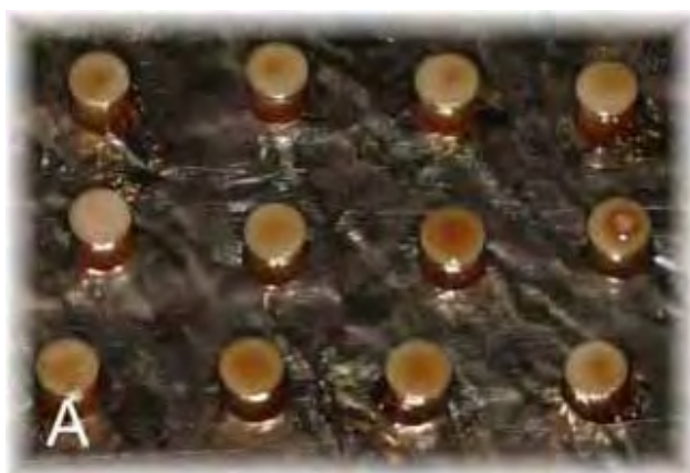
FIGURA 8 - Infiltração do vidro: a) bases dos CP após a infiltração de vidro sobre a lâmina de platina; b) detalhe de uma base com vidro em excesso.
