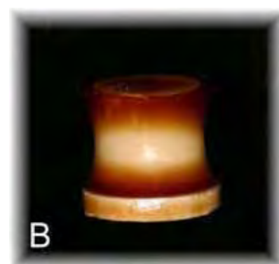
FIGURA 8 - Infiltração do vidro: a) bases dos CP após a infiltração de vidro sobre a lâmina de platina; b) detalhe de uma base com vidro em excesso.
