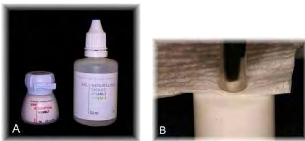
FIGURA 11 - Aplicação do revestimento estético: a) cerâmica de recobrimento estético (VITA VM7); b) eliminação da umidade da cerâmica.
