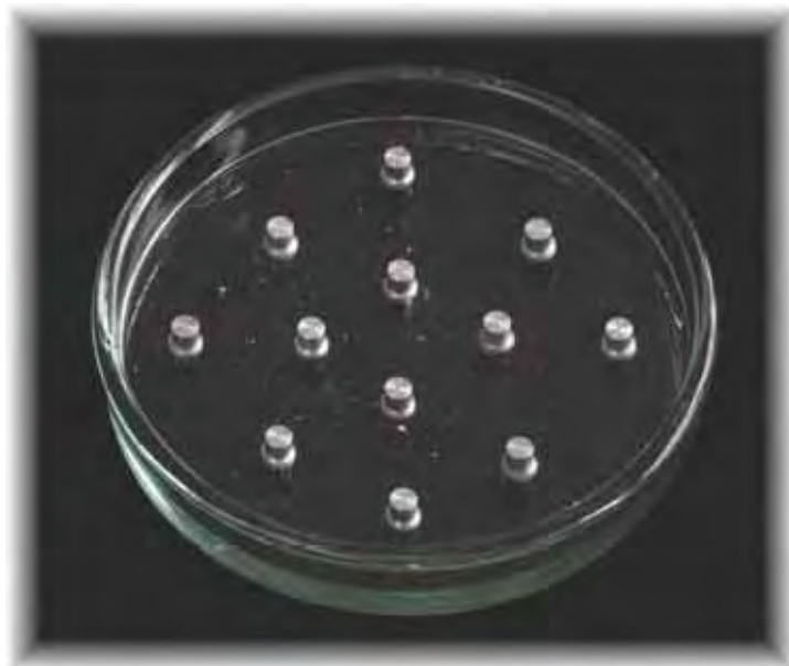
FIGURA 2 - Estruturas metálicas fixadas na placa de Petri com adesivo cianoacrilato.
