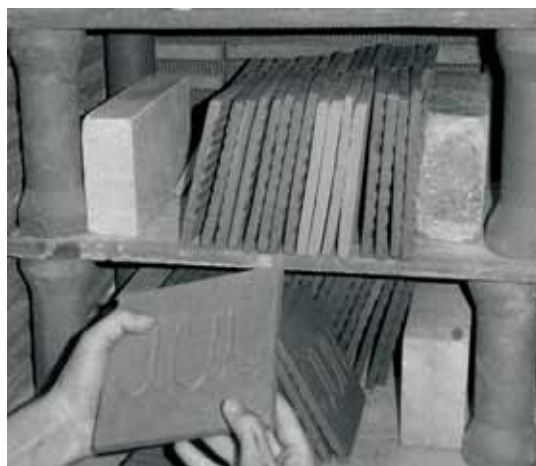
Fig. 95 Daniela Bueno Forno sendo montado para a primeira queima, 2006
