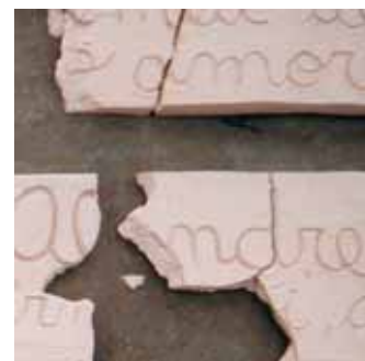
Fig. 97 e Fig. 98 Daniela Bueno Biscoitos trincados da segunda queima, argila paper-clay e os cacos saídos do forno após a segunda queima
