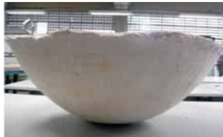
Fig. 127 Daniela Bueno Molde de gesso utilizado para conformação Sala de cerâmica IA-UNESP 2010
