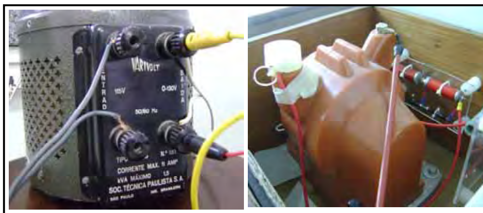
Figura 5.1 – Auto transformador Variac e transformador de alta tensão.
