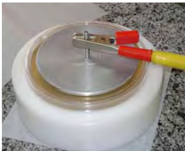
Figura 5.9 – Aparato experimental com eletrodo sobre tampa de plástico.
