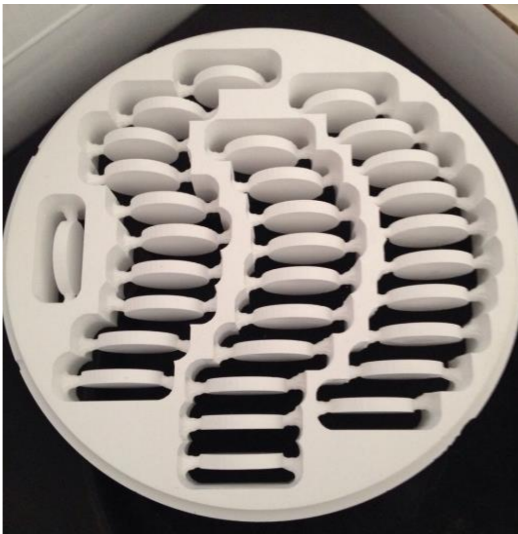
Figura 6 – Bloco de zircônia após usinagem em tecnologia CAD-CAM, para confecção dos discos.
