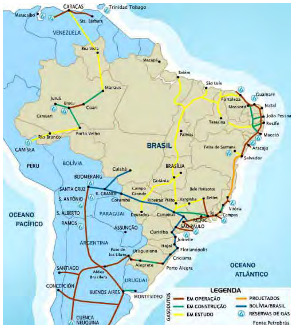
Fig. 3 – Malha de gasodutos do Brasil. (CTGÁS, 2007).
