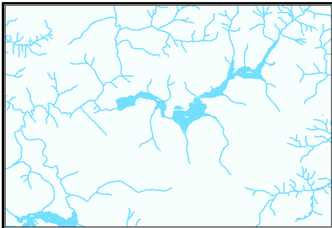
Fig. 9 – Exemplo de informação hidrográfica necessária à definição de rotas e à elaboração do mapa de áreas de preservação permanente. Obtida a partir de cartas topográficas coloridas digitalizadas, com auxílio do programa Adobe Photoshop 9.0, a ferramenta ArcScan no Arcgis 9.2 e tratamento manual no editor do Arcgis 9.2. Especial atenção é dada ao posicionamento de nascentes, várzeas, lagoas e aos diferentes corpos d'água.
