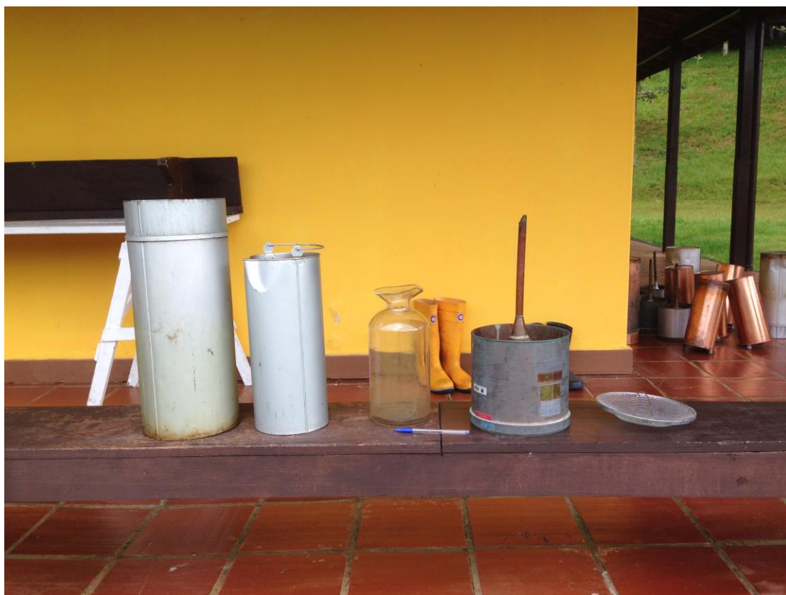
Figura 9. Componentes do pluviômetro. Fonte: acervo do autor, 2018.
