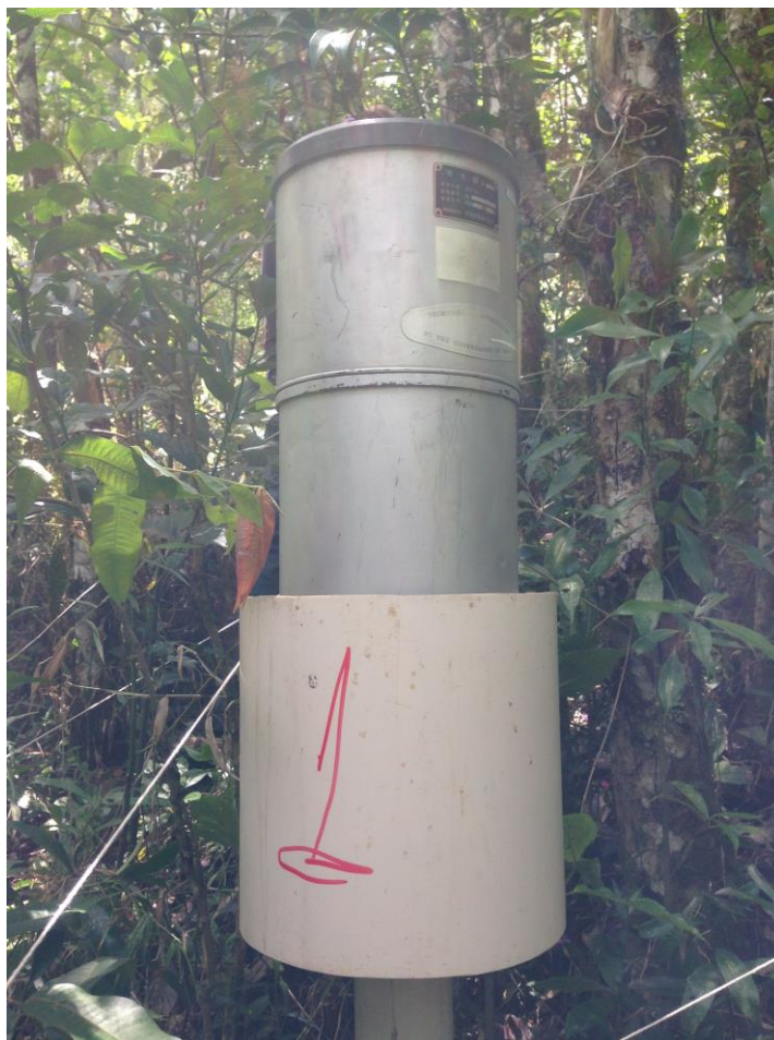
Figura 11. Pluviômetro instalado na parcela. Fonte: acervo do autor, 2018.
