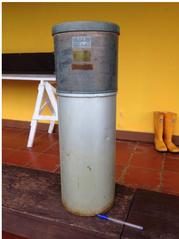
Figura 8. Pluviômetro Nakaasa Corporation. Fonte: acervo do autor, 2018.
