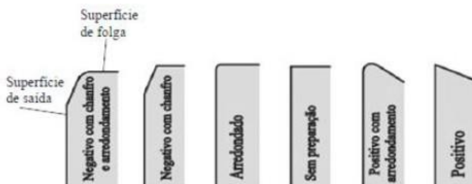
Figura 12 – Geometrias comuns de aresta de corte de insertos.
