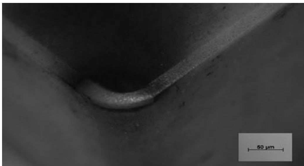
Figura 34 – Deterioração causada pelos parâmetros V_c = 500 m/min, f = 0.2 mm/rot e a_p = 0.5 mm.
