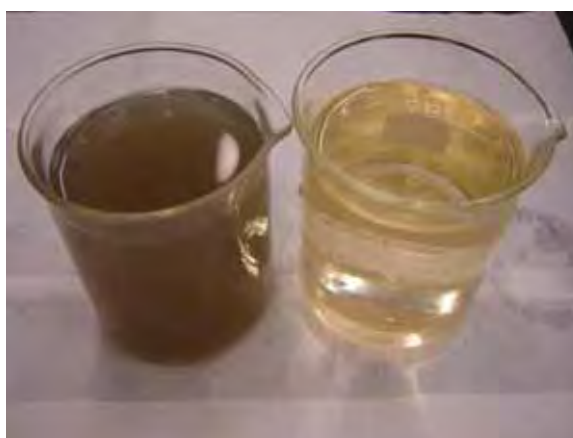
Figura 6.5: Aspecto do afluente bruto (à esquerda) e efluente tratado (à direita)
