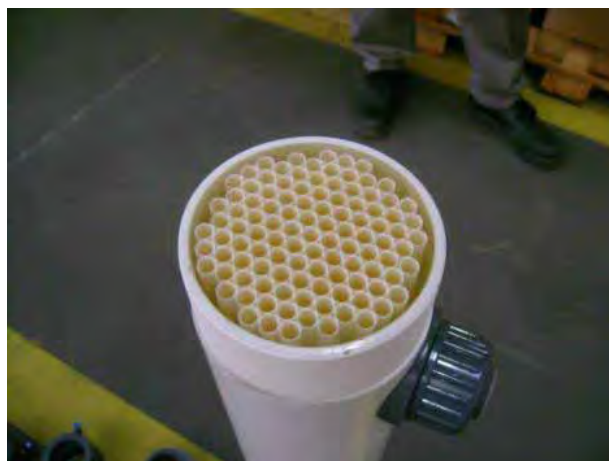
Figura 5.6: Vista superior do módulo de ultrafiltração – detalhe para as fibras tubulares
