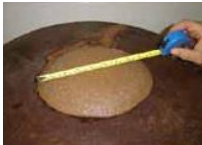
Figura 5. Argamassa feita com pó cerâmico (Grupo de Pesquisa em Materiais de Construção e Estruturas)
