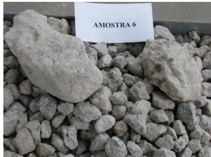
Figura 12 – Amostra 6: Brita 2 reciclada de RCD - Grupo AB Areias em Pindamonhangaba.
