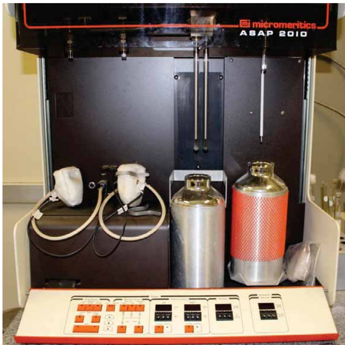
Figura 3.9 – Foto do equipamento utilizado para fazer análises de adsorção de N_2 a 77K.
