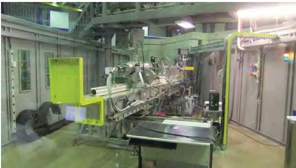
Figura 3.17 – Foto do equipamento de espalhamento de raios-X a baixo ângulo do laboratório nacional de luz síncrotron (LNLS).
