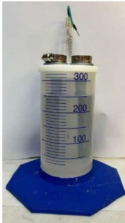
Figura 6: Arranjo experimental para ENA na parte roscada
