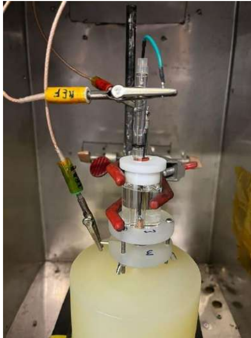
Figura 11: Arranjo Experimental para as medidas de ENA
