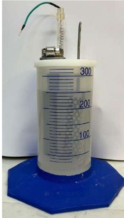
Figura 7: Arranjo experimental para EIS na parte roscada
