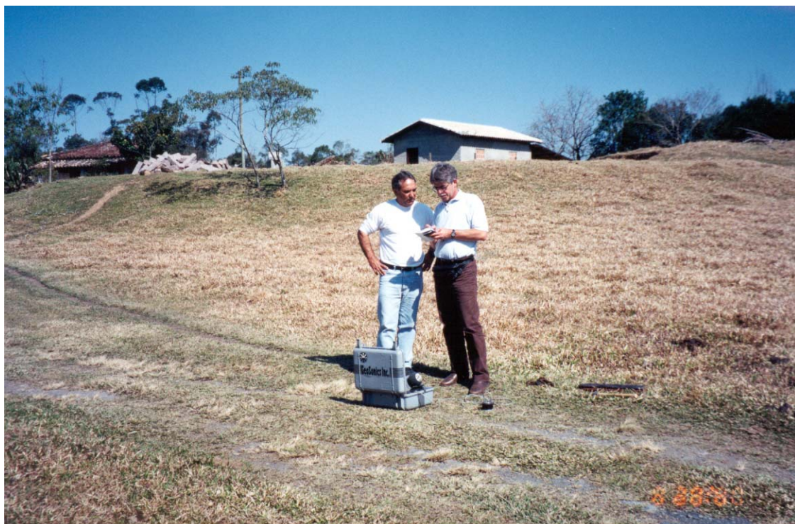
Foto 16 - Ponto de monitoramento número 09, geofone instalado na estrada de acesso à casa de Luis D'Acol, Vila Rio Albina, Siderópolis (SC).
