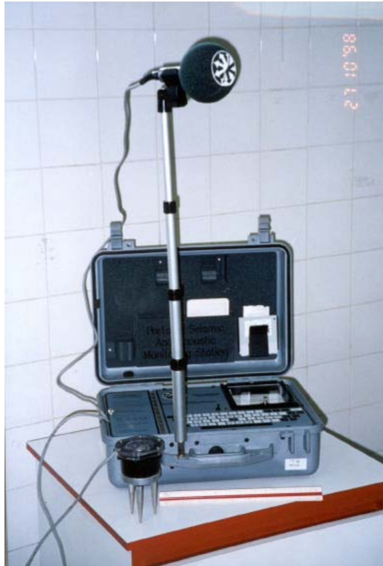
Foto 8 – Sismógrafo de engenharia modelo SSU 2000 DK utilizado no registro das vibrações na área de pesquisa.
