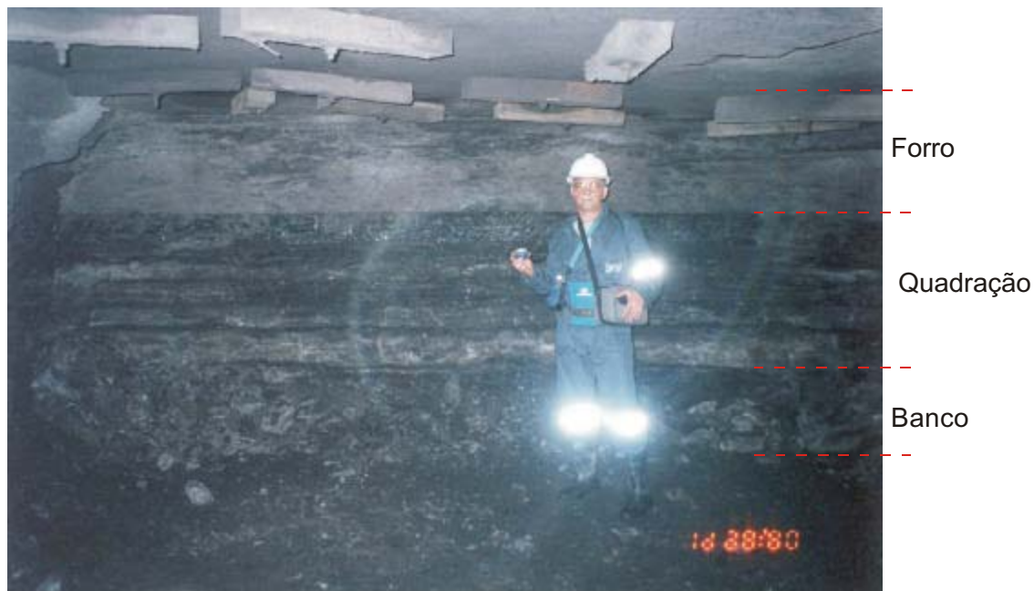
Foto 1 - Frente de lavra da galeria 7, câmara 110, na mina Trevo, Siderópolis (SC); ao fundo a Camada Barro Branco, com detalhe do forro, quadração e banco.
