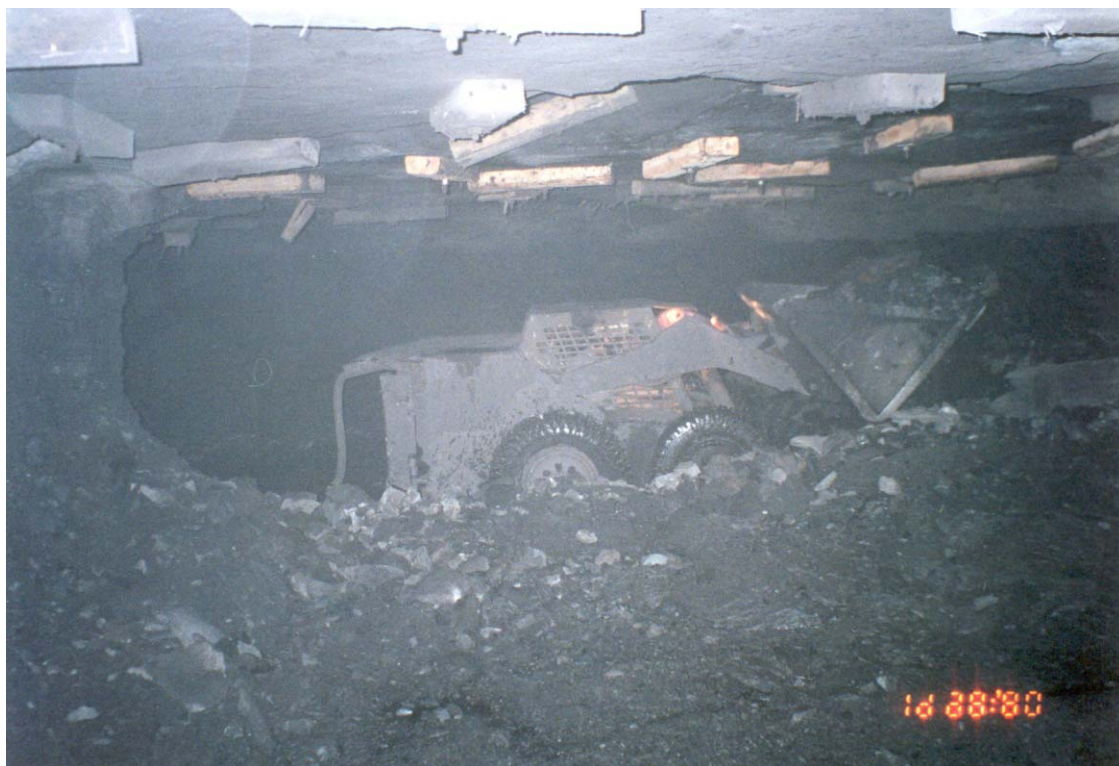
Foto 2 - Operação de carregamento por bob cat , na frente de lavra após a detonação, Mina Trevo, Siderópolis (SC)
