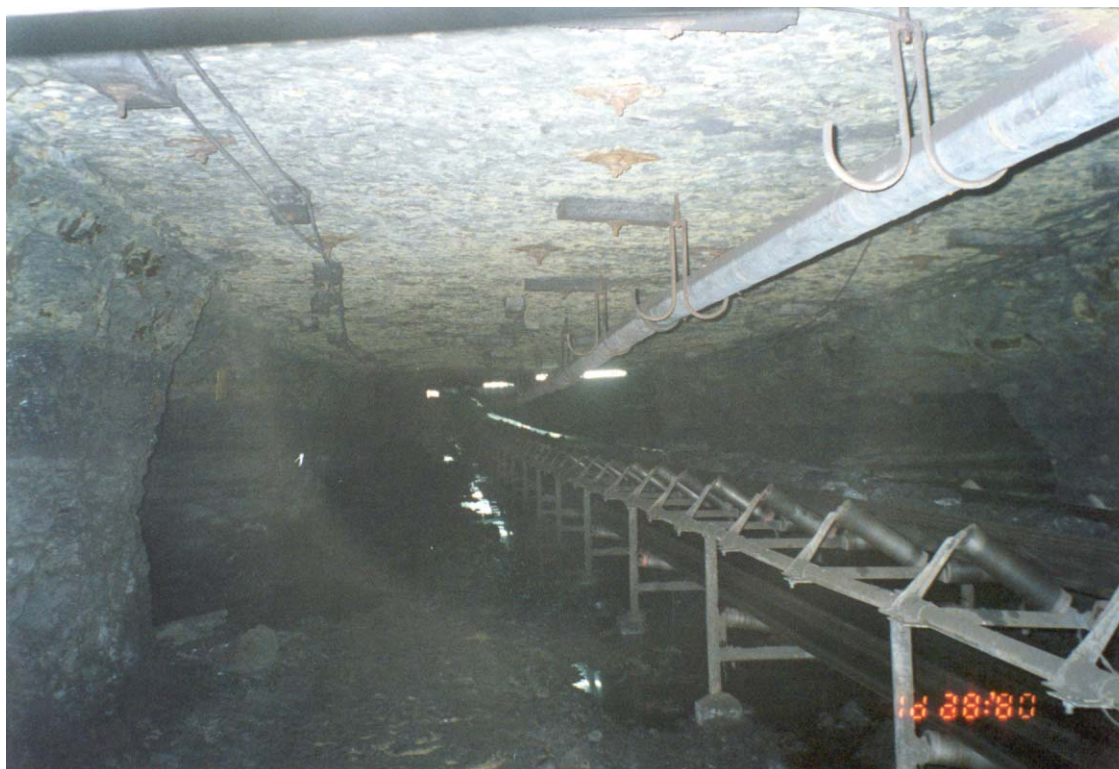
Foto 3 - Transporte do minério por correia transportadora, na galeria principal da Mina Trevo, Siderópolis (SC)
