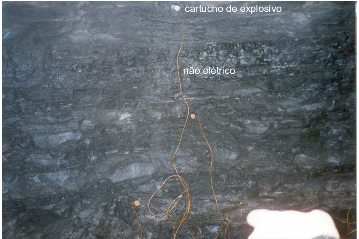
Foto 4 - Frente de extração da Mina Trevo, Siderópolis (SC), com a disposição dos furos de detonação com explosivo e amarração feita com cordel.
