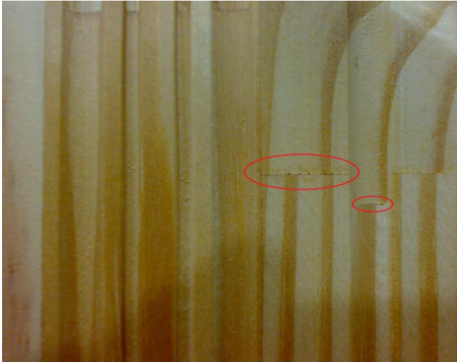
Figura 30 – Peça com defeito – Ponta de agulha – São pontos falhados na linha do finger joint, são difíceis de ver a distancia.
