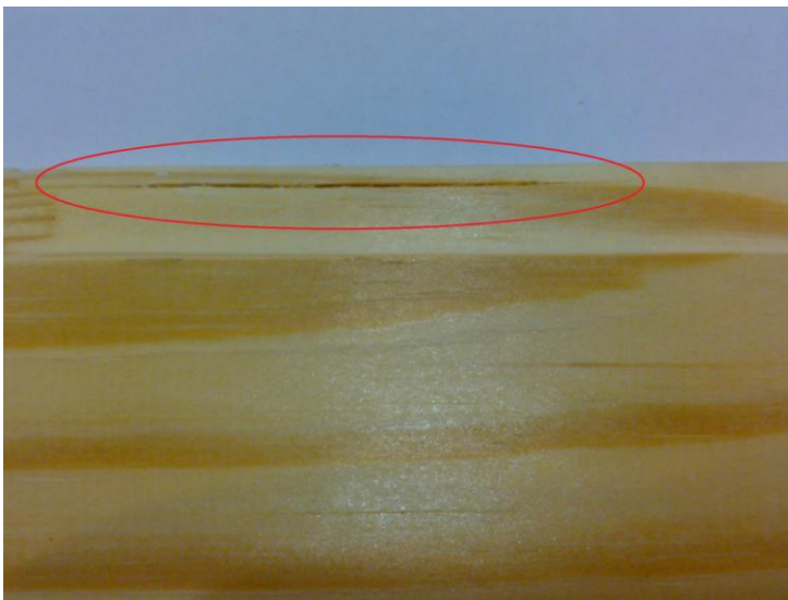
Figura 19 – Peça com defeito – Trinca.
