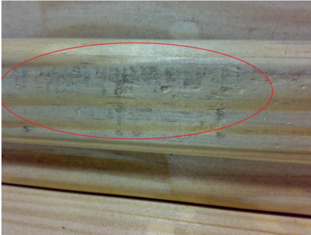
Figura 26 – Peça com defeito – Falha plaina.
