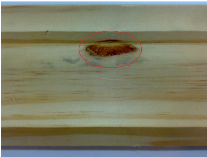
Figura 23 – Peça com defeito – Bolsa de Resina.
