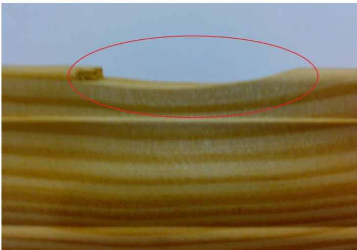
Figura 21 – Peça com defeito – Lascado.
