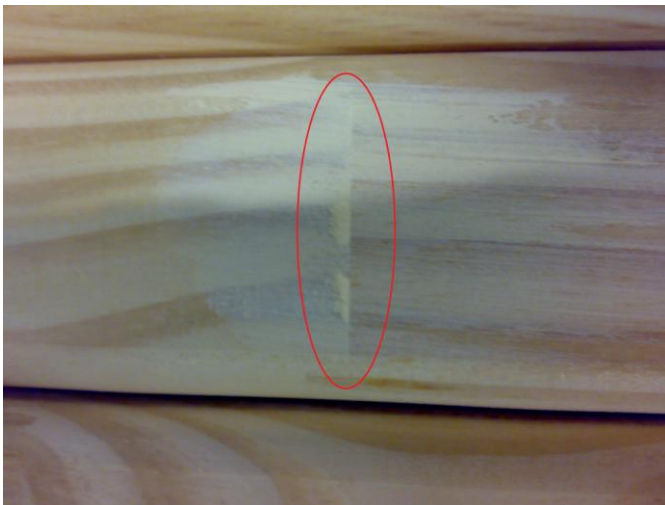
Figura 31 – Peça com massa, quando se tem o excesso de massa ou a má colocação da massa isso gera um defeito, pois no processo adiante necessita ser lixada para melhorar o aspecto.
