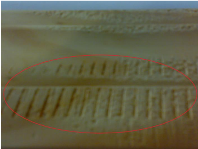
Figura 28 – Peça com defeito – Marca de rolo
