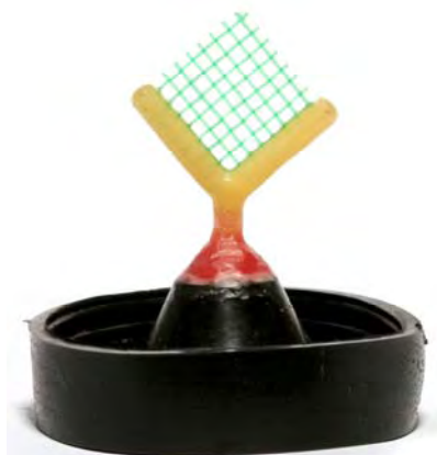
FIGURA 3 – PADRÃO DE FUNDIÇÃO PARA TESTE DE FLUIDEZ.
