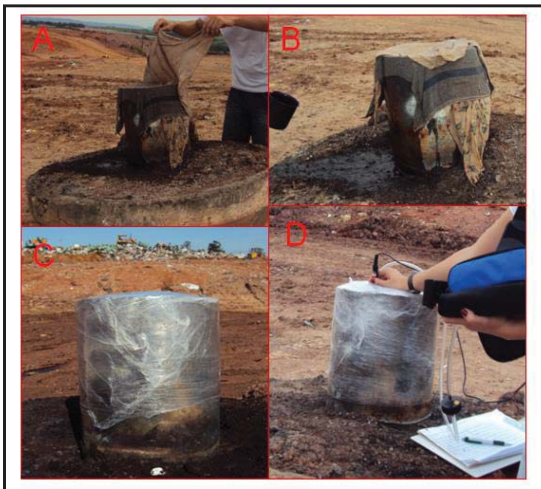
Figura 18. Procedimento de fechamento do dreno de gás para posterior medição.
