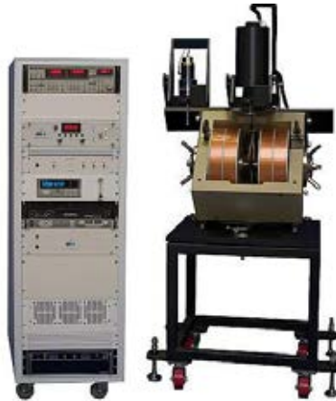
Figura 25 - Magnetômetro de amostra vibrante VSM-ADE EV9-Microsense utilizado para levantamento magnético das amostras.
