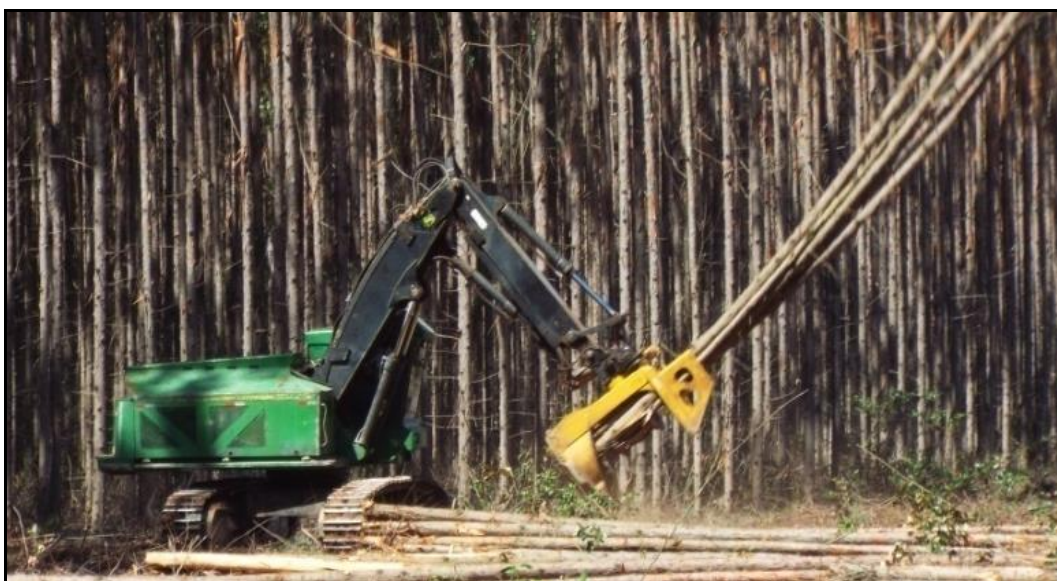
Figura 3: Formação do buncher durante a basculada das árvores.
