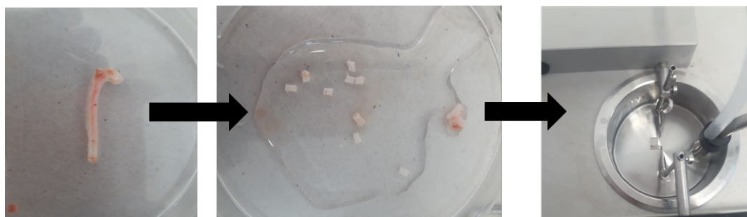
Figura 4. Fotos feita pela autora. Primeira representa a artéria aorta (dissecada), seguida pela artéria cortada em anéis de 4mm e por fim, o miógrafo utilizado nos experimentos de reatividade juntamente com o anel aórtico ajustado em 1,5g.
