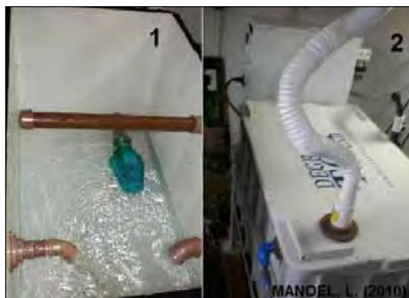
Figura 1. Ozonizador acoplado em tanque de água e com circulação de água movimentada por bomba hidráulica. 1. Processo de inserção de água do abastecimento público no tanque e 2. Tanque de água lacrado e início do processo de ozonização da água e sanitização dos vegetais – 2010 (Foto: MANOEL, L. 2010).
