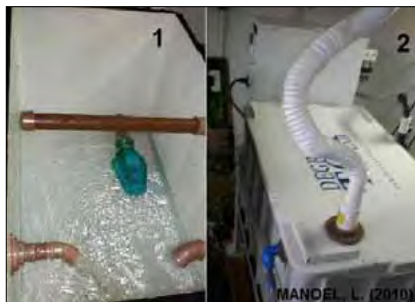
Figura 4. Aparelho de ozonizador acoplado em tanque de água e com circulação de água movimentada por bomba hidráulica. 1. Processo de inserção de água do abastecimento público no tanque e 2. Tanque de água lacrado e início do processo de ozonização da água e sanitização dos vegetais – 2010 (Foto: MANOEL, L.; 2010).
