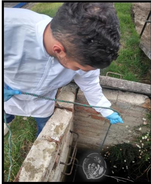
Figura 9 - Amostragem de lodo da ETA.
