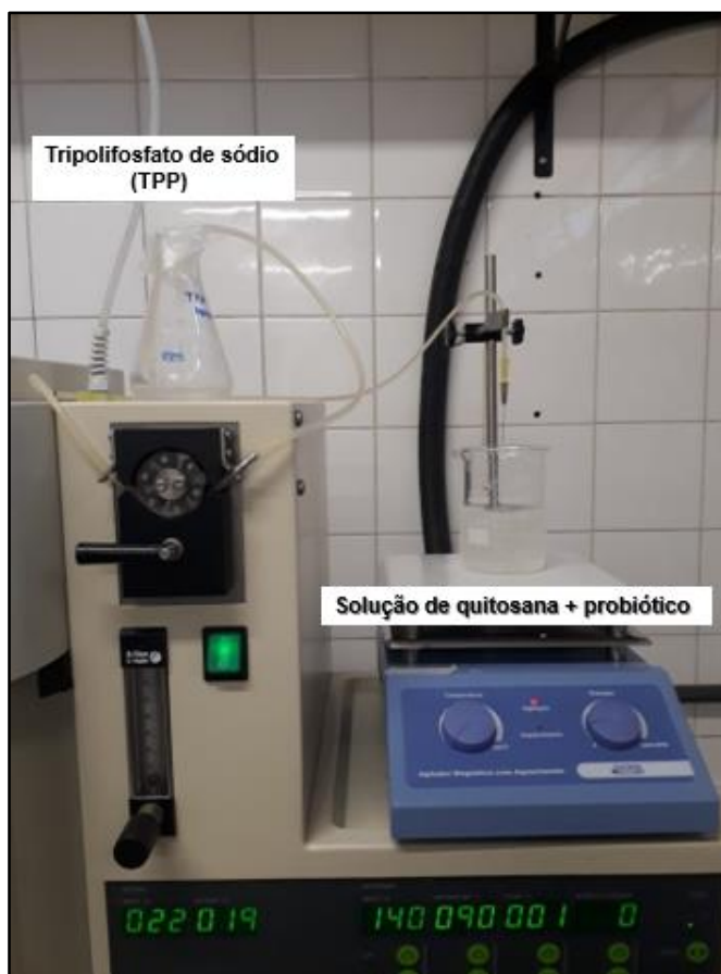
Figura 6: Sistema para obtenção das nanopartículas pelo método de gelificação iônica.
