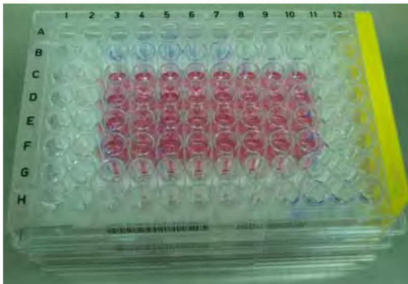
Figura 4 - Placa de cultura celular de 96 poços (TPP, Trasadingen, Suíça), contendo 8 \times 10^3 células em 200 µl de meio de cultura por poço, para verificação da citotoxicidade dos cimentos pelo ensaio de MTT ( Methylthiazolyldiphenyl-tetrazolium bromide , Sigma-Aldrich Brasil LTDA).
