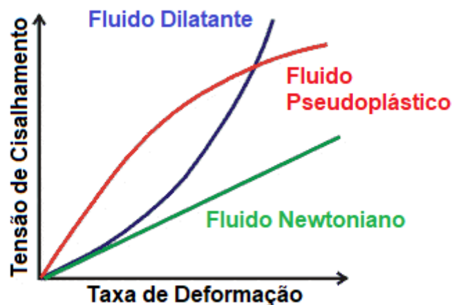
Figura 2 - Comparação Fluido Dilatante, Fluido Pseudoplástico e Fluido Newtoniano.
