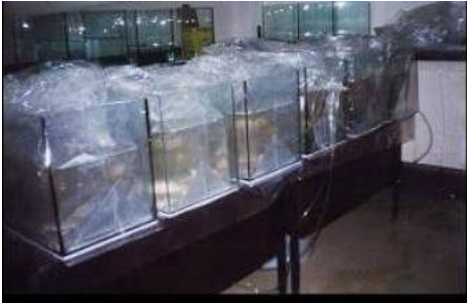
Figura 5 – Aquários utilizados para o teste de toxicidade crônica realizado com tilápia Oreochromis niloticus contaminada com Hg e Se
