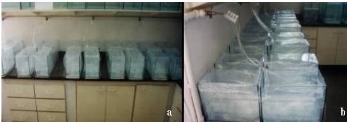
Figura 3 – (a) Vista da bateria de aquários utilizados no teste de toxicidade aguda com Hg e Se, (b) sistema de aeração artificial utilizado durante o experimento de toxicidade aguda com Hg e Se
