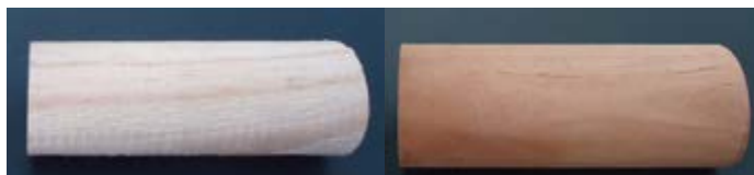
Figura 36 - Preparação final do corpo de prova em formato cilíndrico.
