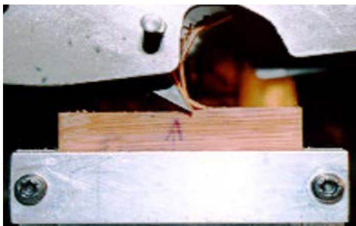
Figura 20 - Formação do cavaco Tipo I.
