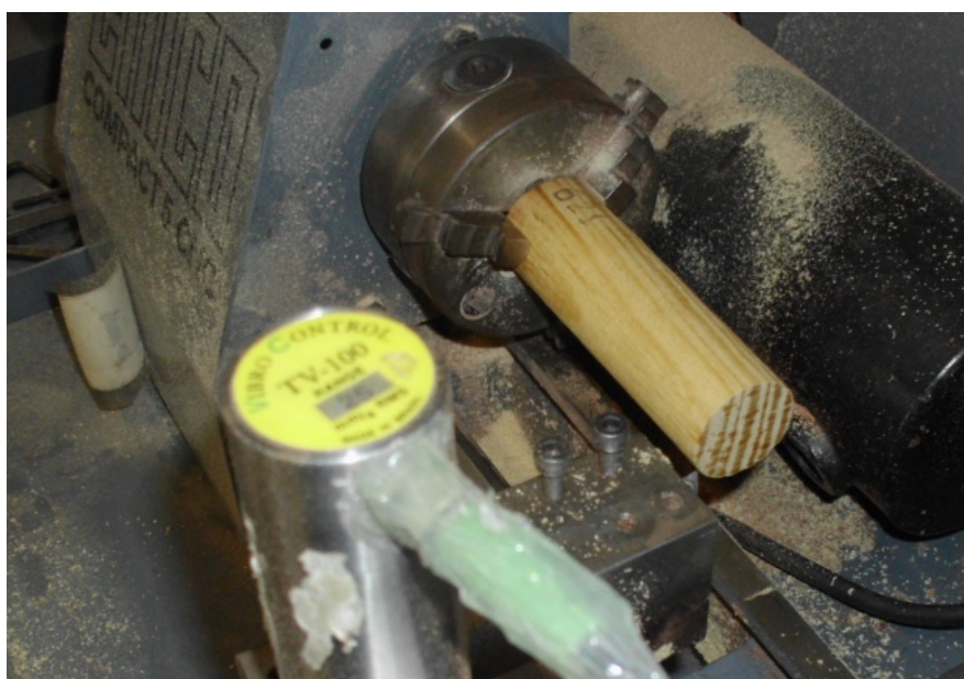
Figura 44 - Posicionamento do corpo de provas no torno CNC.
