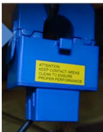
Figura 52 – Sensor de potência utilizado. Marca LEM, modelo AT5B10.
