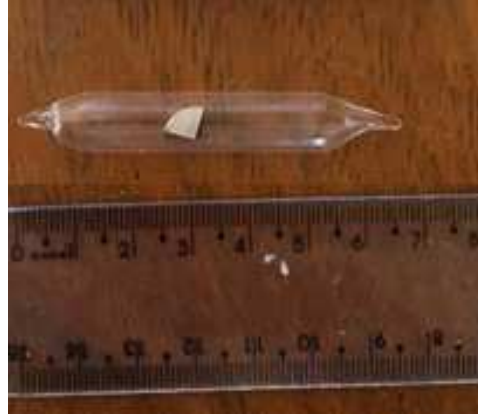
Figura 2 - Amostra encapsulada em tubo de quartzo em atmosfera inerte de argônio.
