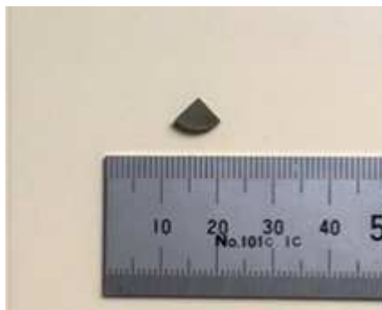
Figura 1- Amostra cortada pela técnica de eletroerosão a fio.
