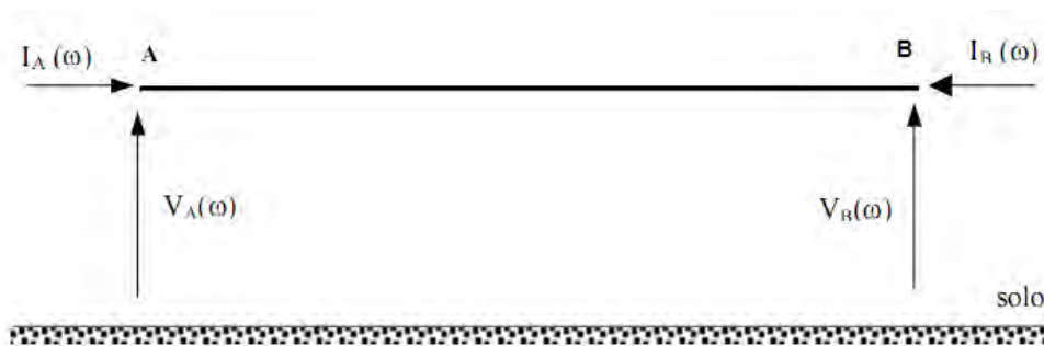
Figura 3.3 – Linha de transmissão monofásica de comprimento d .
