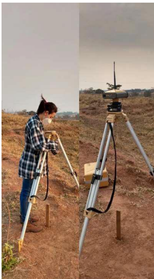
Figura 13 - Receptor fixo do aparelho geodésico Hiper Lite ++, nivelado em um dos pontos mais alto da área mapeada.
