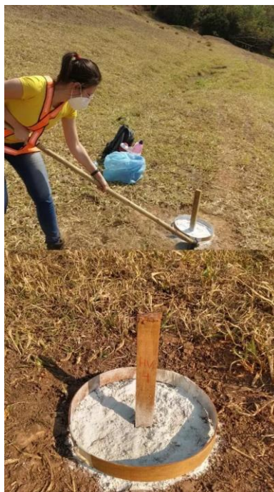
Figura 12 - Demarcação dos alvos nas áreas de vegetação. A estaca era utilizada para que não houvesse perda do ponto caso a pintura com cal apagasse.
