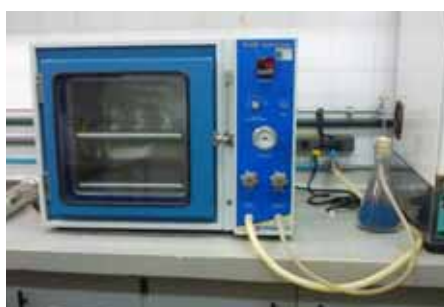
Figura 17. Estufa a vácuo.
