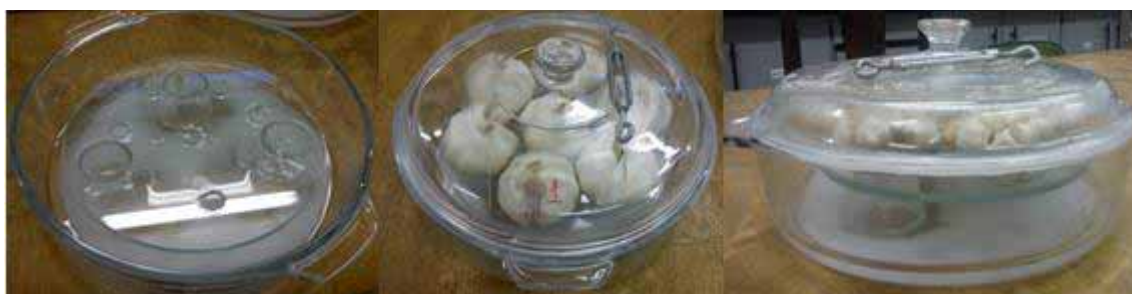
Figura 12. Suportes e recipientes herméticos de vidro para a disposição dos bulbos de alho.
