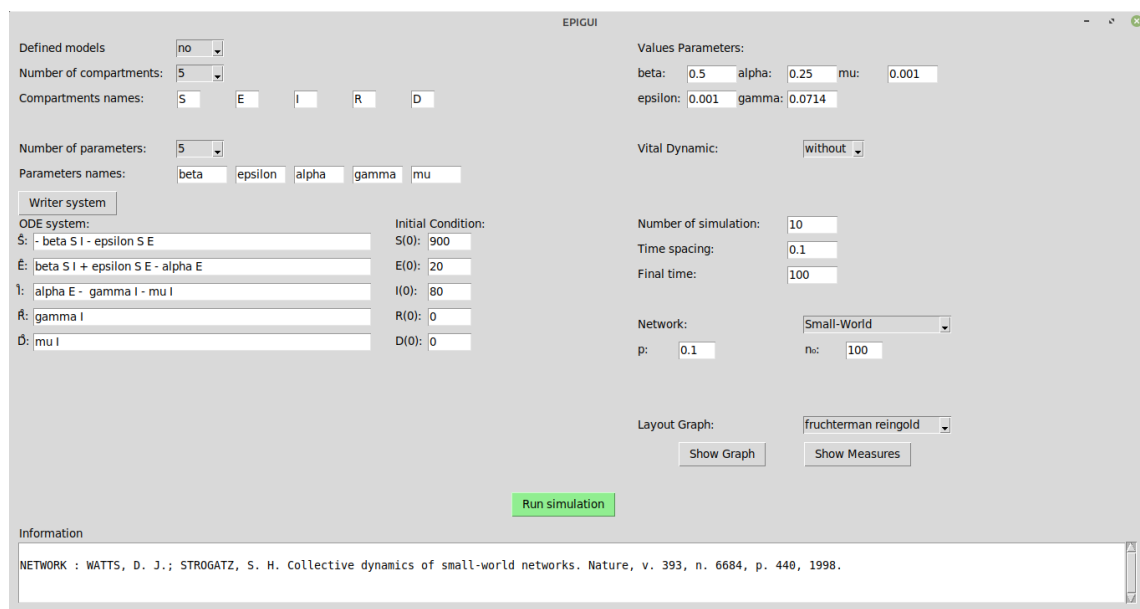
Figura 27: Configuração do modelo SEIRD em conjunto com a rede mundo pequeno na interface EPIGUI.
