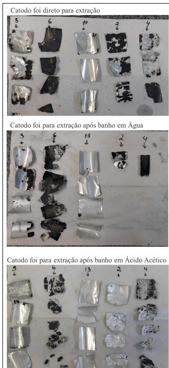
Figura 21 - comparação entre tipos de banho catodo NMC
