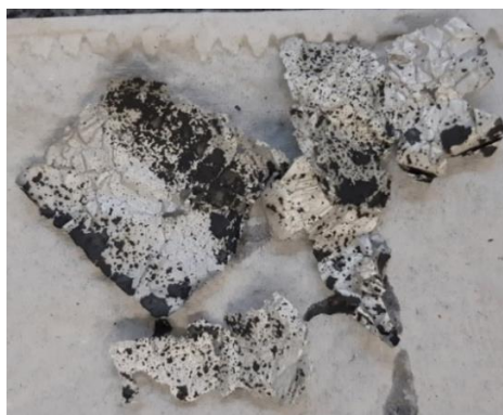
Figura 22 - Alumínios de catodos NMC com textura e coloração diferentes
