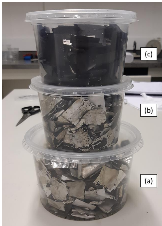
Figura 17 - Alumínios/catodos (a) (b) e (c) - noção volumétrica – Células LCO
