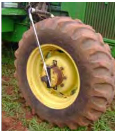
Figura 8. Geradores de pulsos “encoder”.
