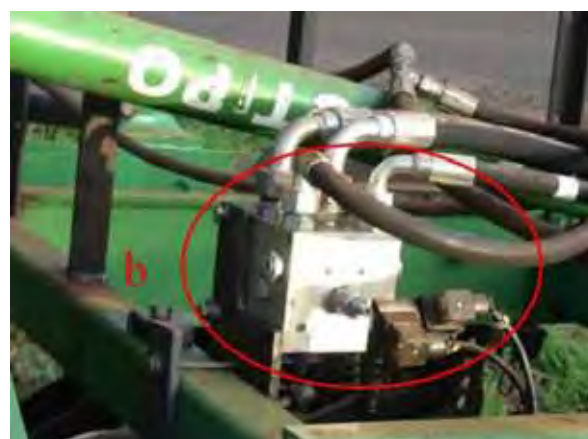
Figura 18. a) Sensor de posição b) caixa controladora de fluxo de óleo
