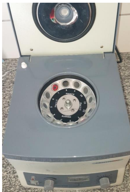
Fig.2- Centrifugação por 10 minutos em 3000 rpm
