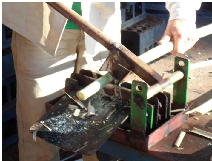
Figura 1. Corte dos minirrebolos com auxílio de uma guilhotina de lâminas duplas.
